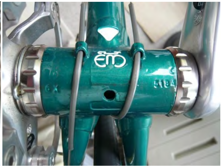
端部の塗装が剥離しチャチ
