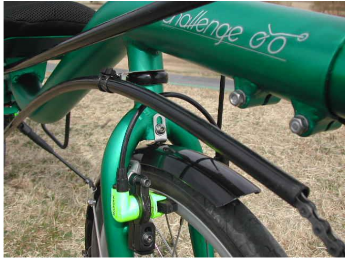
写真5 フロント油圧ブレーキとチェーンガイドチューブ
