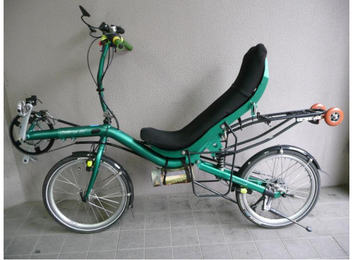
写真12 ハンドルステムは角度調整も可で前後に折れる
